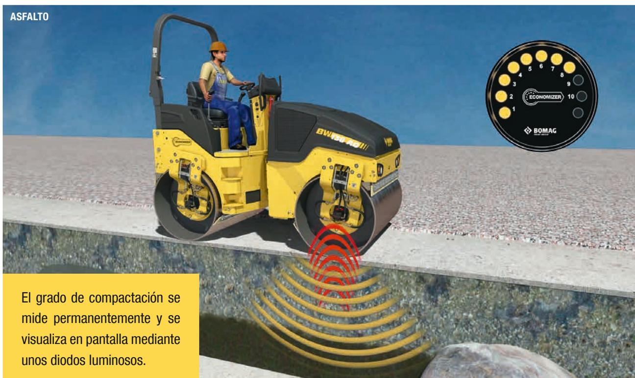
El grado de compactación se mide permanentemente y se visualiza en pantalla mediante unos diodos luminosos.
