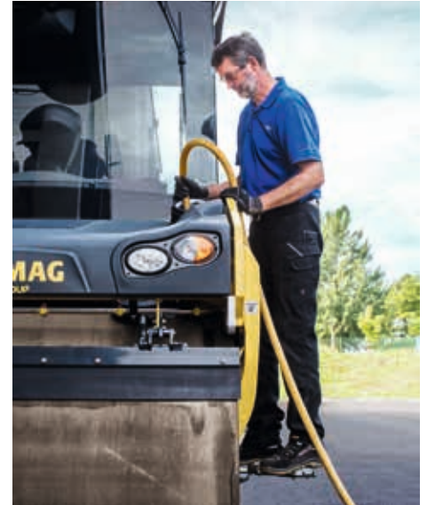
Repostar con comodidad gracias al escalón plegable de seguridad.
