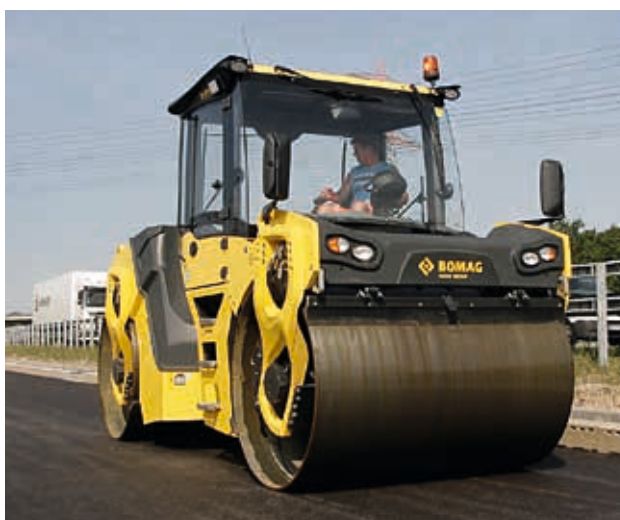
El BOMAG BW 191, con sus grandes tambores, resulta ideal para grandes rendimientos de superficie.
